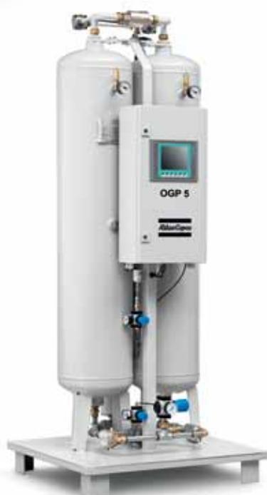
Bei dem neuen Sauerstoffgenerator von Atlas Copco kommt eine Druckwechsel-Adsorptionstechnologie zur Isolierung von Sauerstoffmolekülen in der Druckluft zum Einsatz. Das Ergebnis ist hoch reiner Sauerstoff am Ausgang des Generators. Die Geräte der OGP-Serie sind eine sehr kostengünstige Sauerstoffquelle, die in zahlreichen Branchen wie der Abwasserbehandlung, der Ozonproduktion, dem Gesundheitswesen, der Glasherstellung und vielen anderen Verwendung findet.
